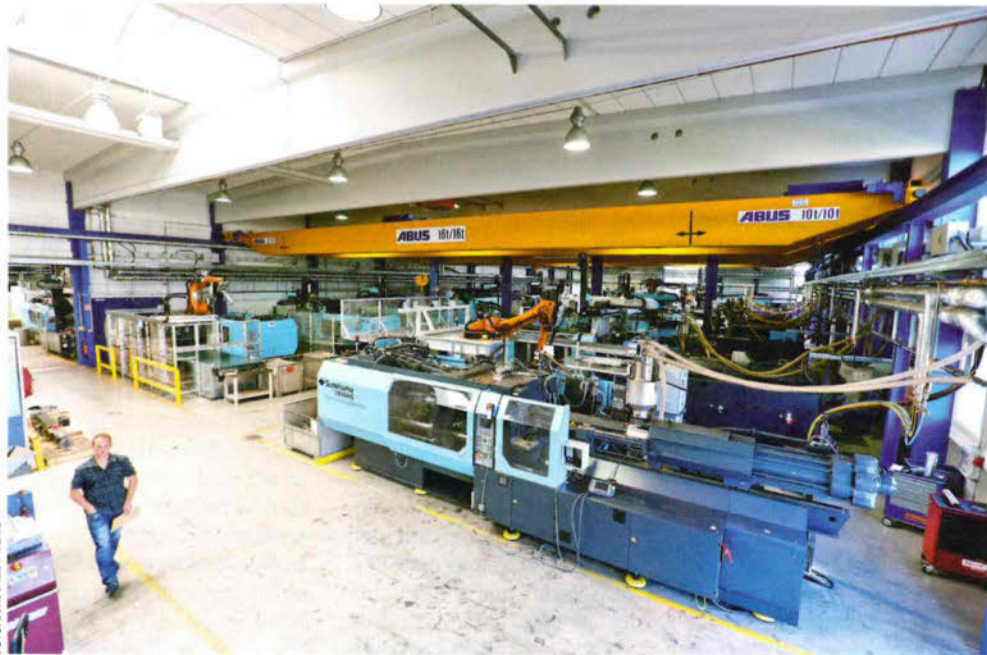
Die Borscheid + Wenig GmbH bietet heute ein umfassendes Angebot von der Fertigung einzelner Komponenten bis hin zu kompletten Baugruppen. Über 40 Spritzgießmaschinen sind im Einsatz.
